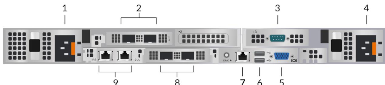
1. Bloc d'alimentation (PSU1) pour connecter sonde à une source d'alimentation en courant alternatif
