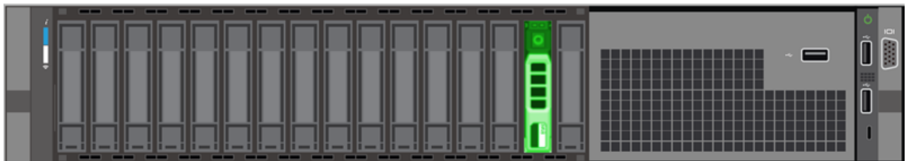
Figure 3: EDA 9200 et EDA 10200 - Emplacement 14
