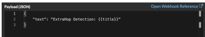
Wir empfehlen, dass Sie Ihre Verbindung zur Webhook-URL testen, bevor Sie die Nutzlast ändern. Auf diese Weise können Sie sicher sein, dass Probleme nicht auf einen Verbindungsfehler zurückzuführen sind.
