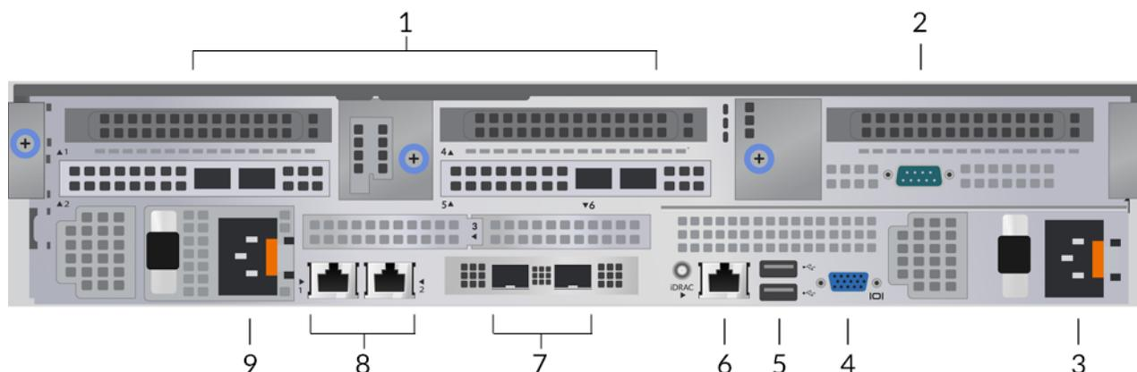
1. Vier 25-GbE-fähige Ports an zwei Netzwerkadaptern. Diese Ports können als leistungsstarke Überwachungsschnittstellen (Erfassung) oder als leistungsstarke ERSPAN/VXLAN/GENEVE-Ziele konfiguriert werden.
