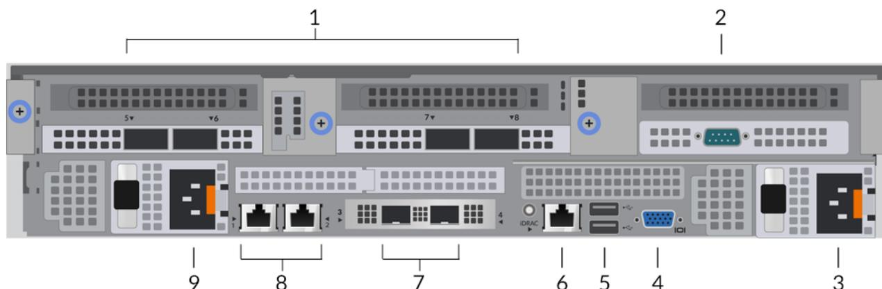
1. Vier 100-GbE-fähige Ports an zwei Netzwerkadaptern. Diese Ports können als leistungsstarke Überwachungsschnittstellen (Erfassung) oder als leistungsstarke ERSPAN/VXLAN/GENEVE-Ziele konfiguriert werden.
